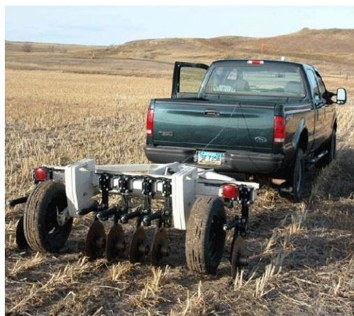
Slika 1.9. Konfiguracija senzora za merenje električne provodljivosti zemljišta Veris 3100
